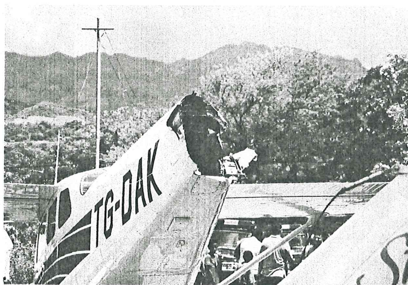
Perdida total de la sección de cola
