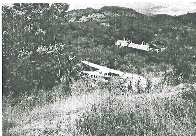
Perdida total del patín de nariz, por impacto directo contra un camino vecinal, al caer de la pista aproximadamente 6 mts.
